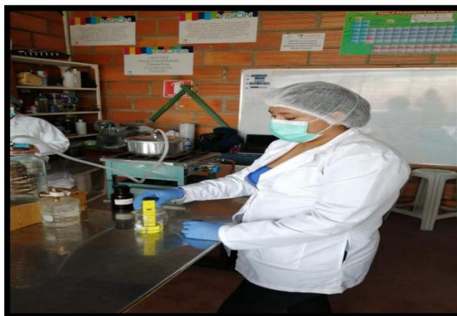
**Figura 8.** Análisis del PH del hidrolato.
