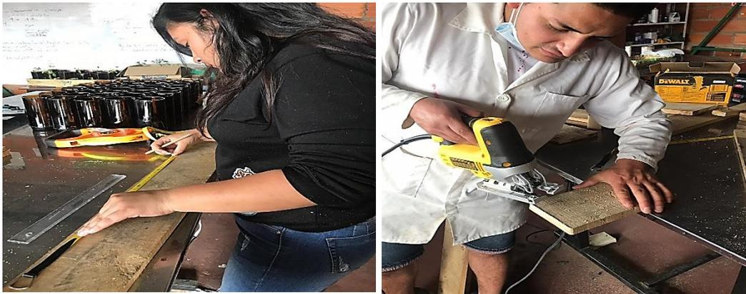
*Figura 10.* Medición y corte de tablas para canastillas
