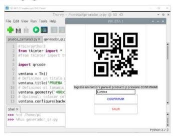
Interfaz gráfica que se muestra en la Figura 29 está compuesta por los widgets mencionados en el apartado 8.1.5 del paquete Tkinter. Dentro de los ensayos realizados el generador de códigos presenta una rápida respuesta cuando se presiona 'confirmar'
