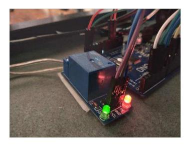
Para empezar con el funcionamiento del sistema, se procede a colocar el primer paquete se espera 1 segundo hasta que el sensor A detecta al objeto como lo muestra la Figura 35 lo que permite el módulo relay tal como lo presenta la Figura 36 que acciona el motor de la banda transportadora.
