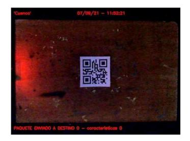
Mientras la cámara enfoca la imagen del código QR tal como se ve en la Figura 38, el sensor C es el encargado de funcionar como disparador para capturar el código QR.
