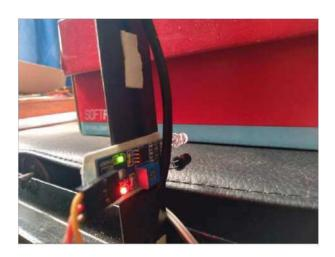
Cuando el paquete llega hasta el sensor B como lo presenta la Figura 37 este envía una señal al microcontrolador Arduino UNO simultáneamente interactúa con un buzzer
