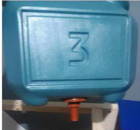
La ubicación del reservorio de agua está en la parte superior izquierda sujetado entre dos listones de madera, mientras que, el reservorio de croquetas está anclado con tornillos en la parte superior derecha con refuerzos a los costados para que soporte el llenado del mismo, en su base se encuentra atornillado un tubo PBC de 3 pulgadas por el cual va a pasar el tonillo sin fin, como podemos observar en la Figura 16.
