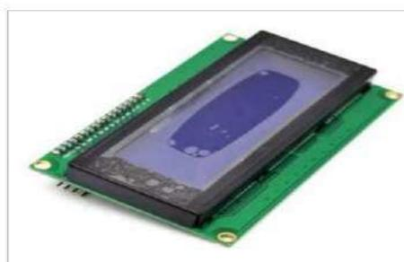
Las pantallas Lcd I2C son dispositivos que permiten la visualización de caracteres, números y símbolos, que gracias al módulo I2C facilita el manejo de la misma, opera con una alimentación de 5V con un consumo de 125mA. La aplicación de este elemento en el presente proyecto es la de poder visualizar el peso en gramos de la ración suministrada en cada comida, lo cual permite llevar un mejor control del correcto balance alimenticio de la mascota.
