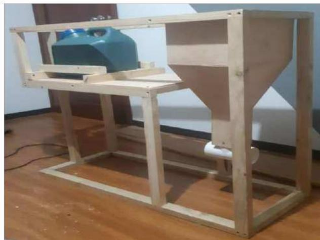
En la Figura 17 se puede observar el diseño de un tornillo sin fin que será ubicado en la parte inferior del reservorio de alimento dentro de un tubo de tres pulgadas, esto con la finalidad de facilitar la dosificación de croquetas en base a un sistema de arrastre mientras el tornillo gira, de manera que, permita controlar de forma fácil la ración suministrada en cada comida.
