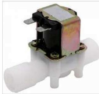
Es un componente que permite controlar el flujo de fluidos, opera con un voltaje de 12V, su diámetro interior es de 14 mm, mientras que el exterior de 16 mm, el tiempo de respuesta en abrir es de 0.15 s, en cambio, al cerrar es de 0.30 s. Tiene la función de permitir o cortar el paso de agua almacenada en un contenedor según se requiera.
