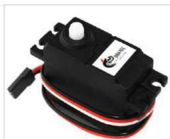
Es un motor con engranajes metálicos, posee un ángulo de rotación de 360°, opera con voltajes desde 4.8V (8.5 Kgf) a 7.2V(10 Kgf). Este actuador acata ordenes
