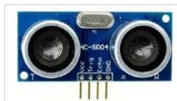
Es un elemento que mide o calcula distancias empleando ondas ultrasónicas. Su voltaje de trabajo es de 5V con una corriente de 15mA, el rango de distancia que
