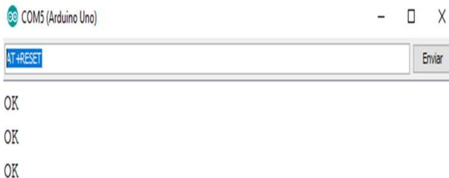
**Figura 23** Resetear valores de fábrica at+reset
