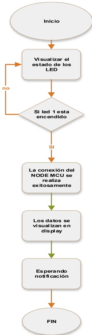
**Figura 40** Proceso de estado Led1
