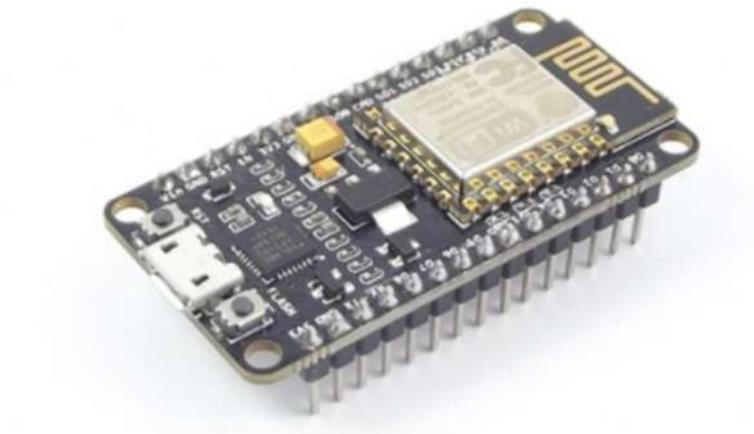
**Figura 4** Placa NodeMcu v2 ESP8266
