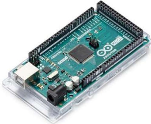
**Figura 3** *Arduino Mega 2560 REV3.*
