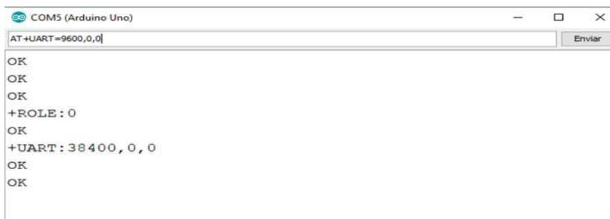
**Figura 29** Comando para configurar el monitor serial que debe ser igual que el maestro
