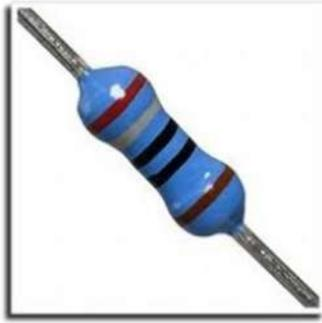
**Figura 16** Resistencia 220 1/4W
