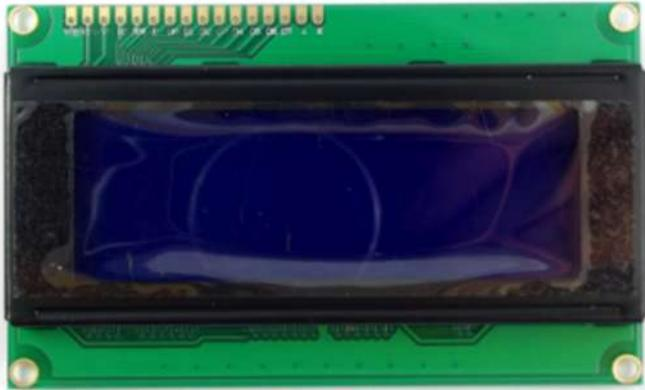
**Figura 6** Pantalla alfanumérico LCD 20X4
