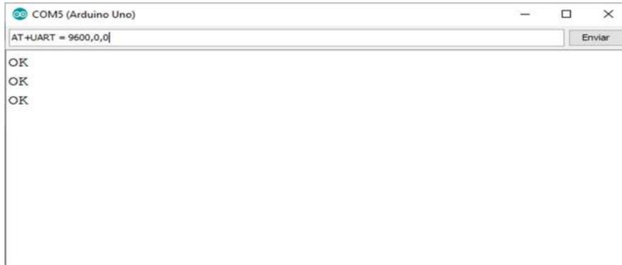
**Figura 34** *Configurar el monitor serial que debe ser la misma que el esclavo*
