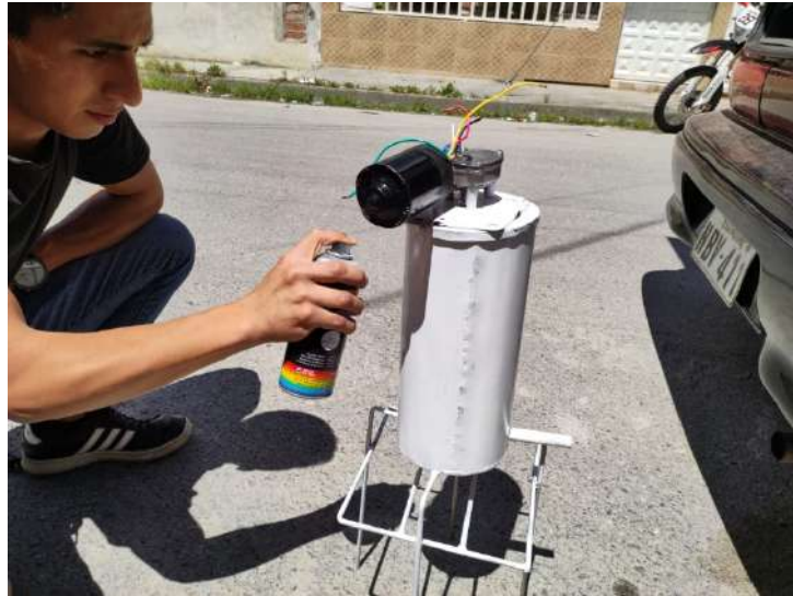
Ilustración 51 Pintado de los tanques
