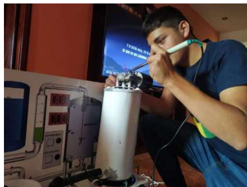
Ilustración 55 Soldado de los cables del motor agitador
