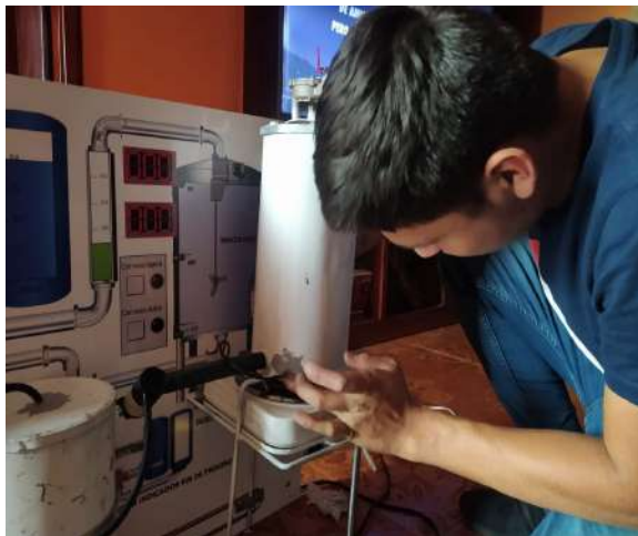
Ilustración 54 Sellado de los tanques
