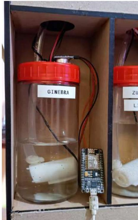
Dentro de cada depósito se encuentra una bomba sumergible como se ve en la figura 28 y en la tapa un sensor ultrasónico, la bomba transporta el líquido del depósito al vaso en una cierta cantidad y el sensor la distancia en centímetros sobre el nivel que tendrá el líquido en cada depósito su medición lo hará desde la tapa donde estará situado cada dato será enviado a una plataforma web para su monitoreo, es ahí donde entra al mundo de la IoT y además su enlace a una red social como es Telegram.
