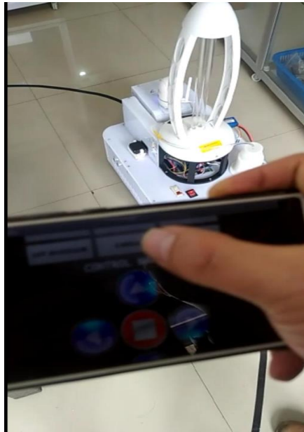
Figura 61 Prueba mediante la app en el celular
