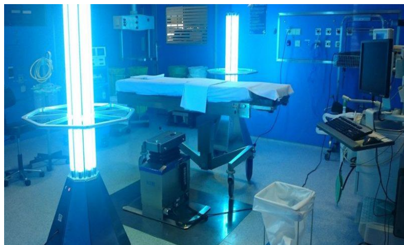
Figura 8 Desinfección mediante luz ultravioleta en ambientes cerrados
