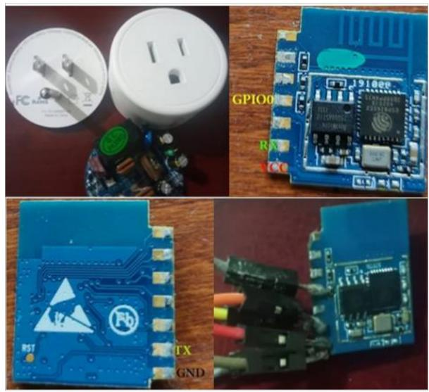
2. Conexión USB Serial con los pines del Smart Plug
