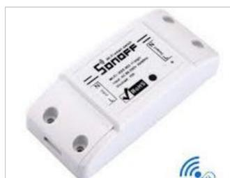
Para utilizar este dispositivo en la domotización del hogar, se procede a clonar el Sonoff para modificar el firmware a través de Tasmota, con el fin de integrar al servidor domótico y permitir el control del mismo.
