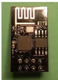
Las características del ESP8266, son las que se indican en la siguiente tabla y debido a su amplia funcionalidad con la red inalámbrica lo hacen un microcontrolador ideal a ser configurado para realizar una automatización.
