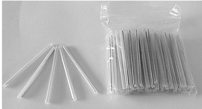
Los protectores de fusión están compuestos por 2 tubos de material termo-retráctil y una varilla de acero inoxidable entre ellos para dar una rigidez y protección en la fusión. El objetivo de su utilización es mantener intactas las propiedades ópticas de transmisión y aumentar la protección de los empalmes de fibra óptica.
