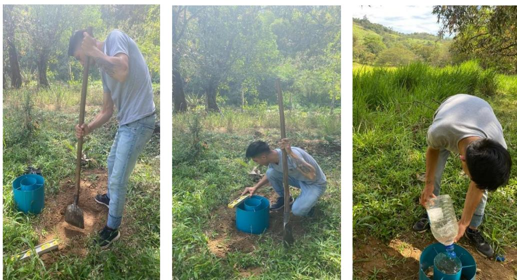
*Nota:* Se utilizó un infiltrómetro de doble anillo.
