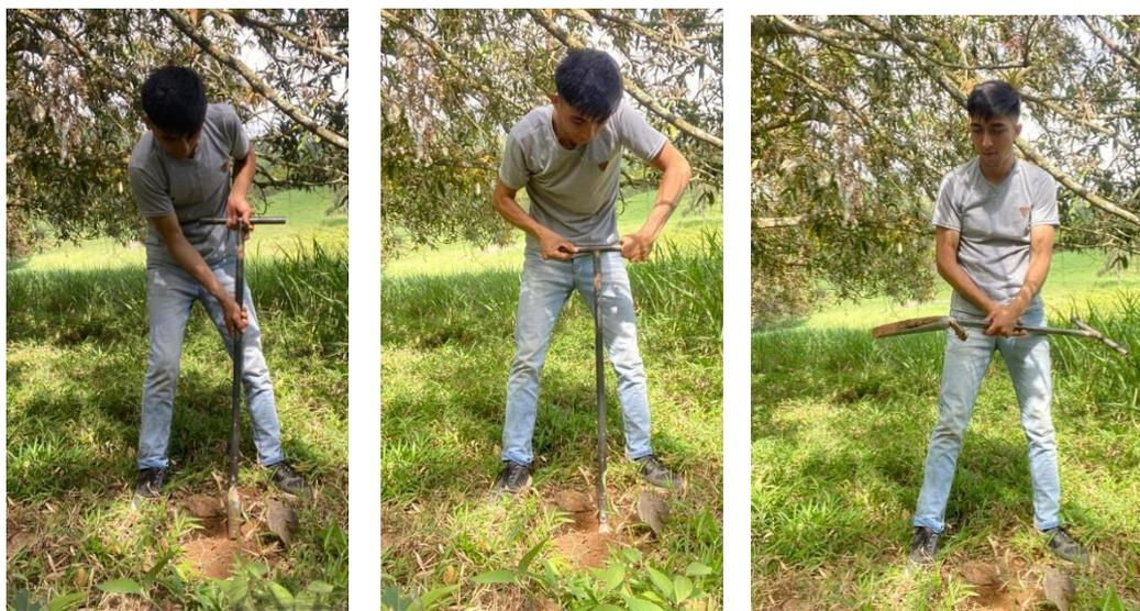
*Nota:* Se utilizó un barreno para obtener muestras de suelo.
