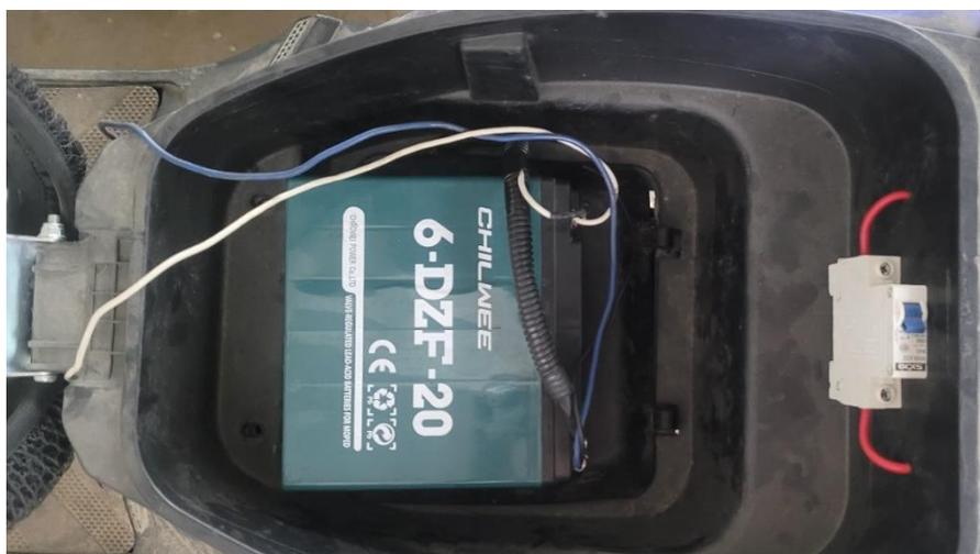
**Imagen tomada de:** *Instalación del acumulador de energía recuperada*
