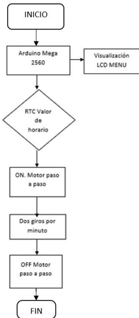
**10.3.2.1. Sección Arduino:** Se muestra el sistema principal en la que por medio de una placa de Arduino Mega 2560 ejecutara todas las órdenes encomendadas en la programación para realizar las acciones correspondientes, en la figura 29 se refleja el proceso mediante diagrama de flujo:
