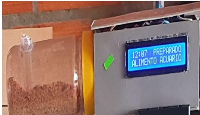
Podemos visualizar el funcionamiento correcto del dosificador de alimento para los peces de forma automática y manual, el cambio de hora se puede desplazar a varios horarios mediante un joystick y visualizar mediante su pantalla LCD.
