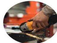
El corte es una operación realizada a mano con la ayuda de máquinas destinadas para esta operación, consiste en dividir el material en varias partes total o parcialmente, se puede utilizar amoladora con disco metal 7 Norton, metal 4.5 Norton, disco Norton 41 2 x 3 16 x 7 8, que hacen de esta operación más rápida la cual se disminuye considerablemente el tiempo de fabricación.
