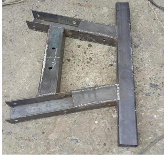
*Nota:* Base de la estructura en proceso de soldadura, fotografía elaborada por los autores.
