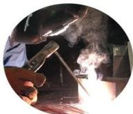
Son varillas revestidas que constan de un núcleo metálico generalmente de forma cilíndrica, recubierta de sustancias no metálicas con composiciones químicas que pueden ser variadas según las características que se necesitan, este electrodo posee un revestimiento de tipo celulósico diseñado para ser usado por corriente alterna, pero también se lo puede usar con corriente continua, este es un electrodo positivo aplicado a soldar la estructura metálica.
