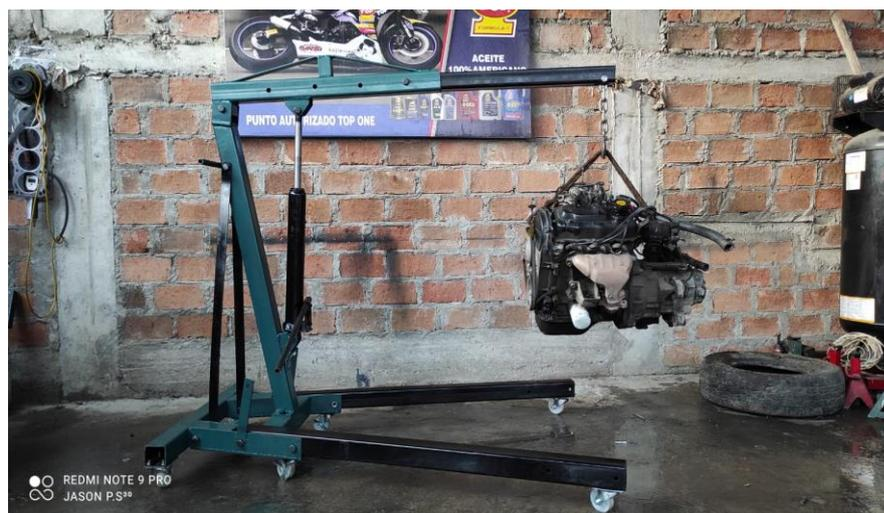
*Nota:* Se muestra la segunda prueba de media tonelada de peso del motor Suzuki.
