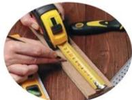
Es la operación por la cual se compara en magnitud una pieza de la otra, con el fin de conocer cuánto vale cada magnitud con exactitud según la implementación de los instrumentos empleados para dicha etapa de proceso de construcción. Los instrumentos de medición nos facilitan a realizar este proceso. El más utilizado para el desarrollo de la construcción es el flexómetro.
