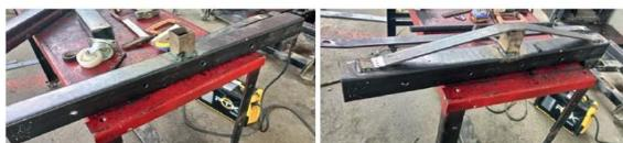
Se corta un tubo de 90 cm de largo, soldando un apoyo cuadrado en la parte superior conjuntamente con la platina de 1/2 x 1/4 38 x 6mm con la soldadura invertir y electrodo 6011.
