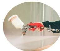
Es el proceso final de la construcción de la grúa hidráulica donde se le da un acabado, con el objetivo de cuidar la estructura de los ataques de la oxidación producida por el ambiente, la pintura anticorrosiva es una base o primera capa de imprimación de pintura que se ha de dar a una superficie, el pintado se debe realizar lo más uniforme posible para evitar una mala presentación en el producto final y de esta manera también se economiza al gastar una mejor cantidad de pintura.
