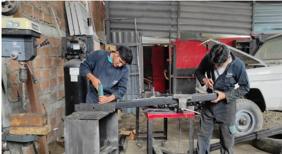
*Nota:* Proceso de pulido en orificios de las extremidades y pulido en zonas de soldadura aplicada en cordón media luna.
