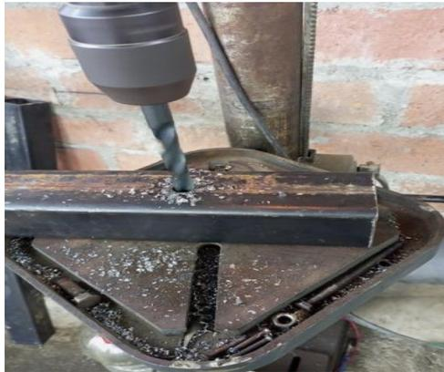
*Nota:* Proceso de perforación con taladro de columna, fotografía elaborada por los autores.
