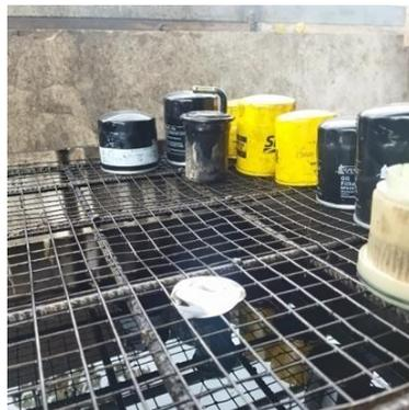
Nota: La imagen contiene información sobre la manera correcta de ubicar en depósitos con malla para escurrimiento de filtros de aceite y gasolina para evitar la contaminación.
