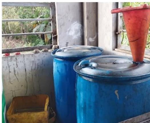
Nota: imagen de autoría propia, el cono es un tipo de embudo artesanal que facilita el vaciado de fluidos a los depósitos evitando derrames.
