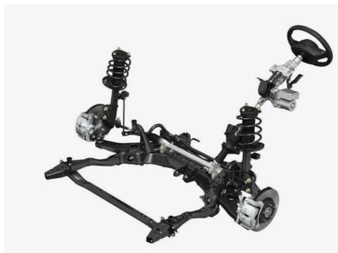
*Nota.* Conjunto del sistema de dirección y suspensión de un automóvil. Reproducido de sistema de dirección, de José Luis R, 2020 (<https://como-funciona.co/sistema-de-direccion/>).
