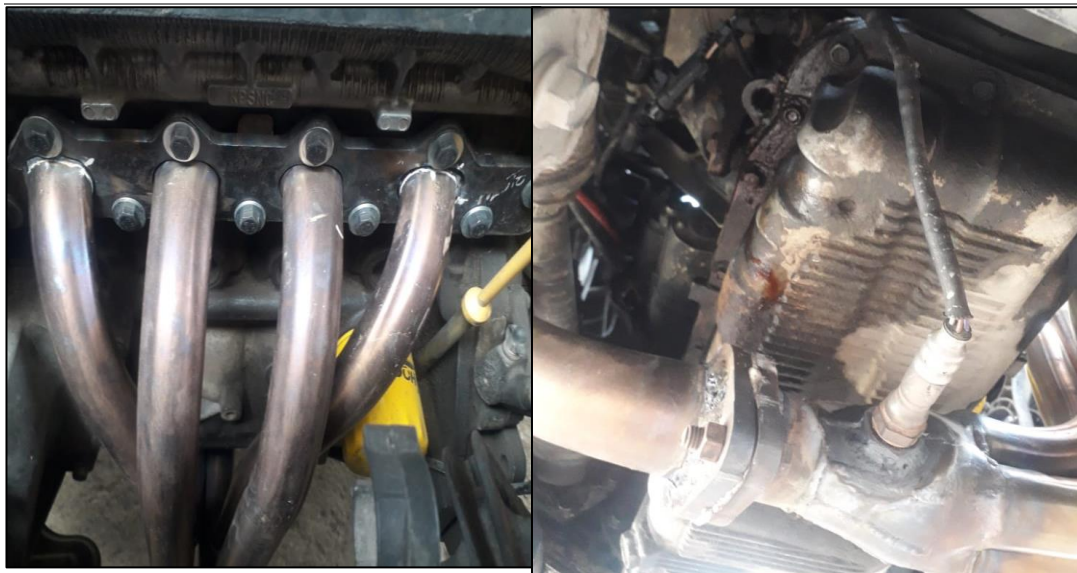
Figura 9. Ensamblaje final del conjunto del colector de escape.
