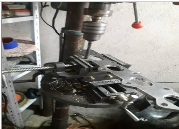
Figura 3. Proceso de avellanado para pernos de sujeción. Construcción de colector de escape.
