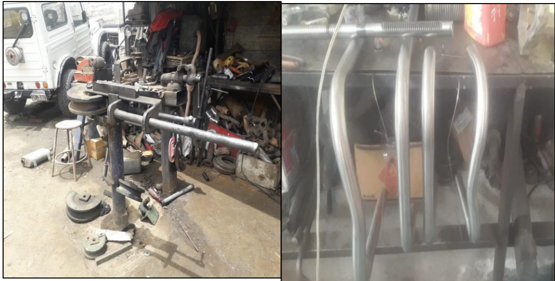
Figura 4. Dobladora de tubo para sacar las curvas para conductos del colector de escape.
