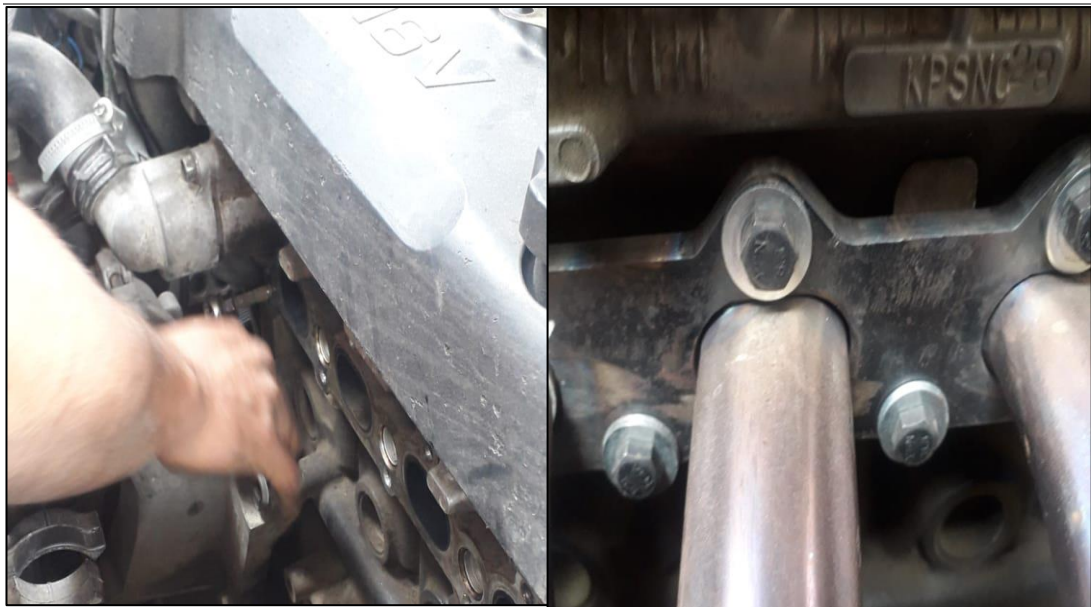
Figura 7. Cambio de espárragos y puesta de pernos M8 con Arandela.
