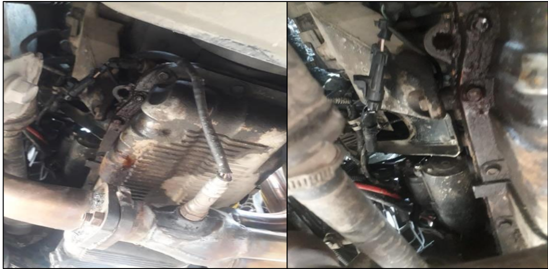
Figura 8. Posición del sensor de oxígeno y alargamiento del socket del mismo sensor.
