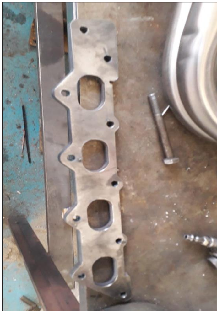
Figura 1. Proceso final de la placa del colector de escape.
