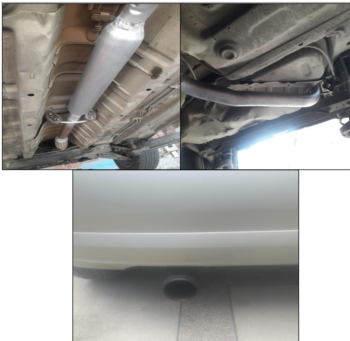
Figura 10. Ensamble final de los conductos después del colector de escape.
