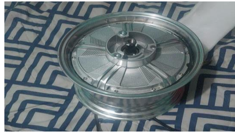
Fig. 21 Motor eléctrico Brushless DC 60V 2000W
