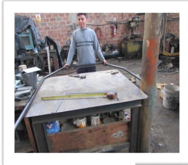
Fig. 38 Tubos doblados de la base
