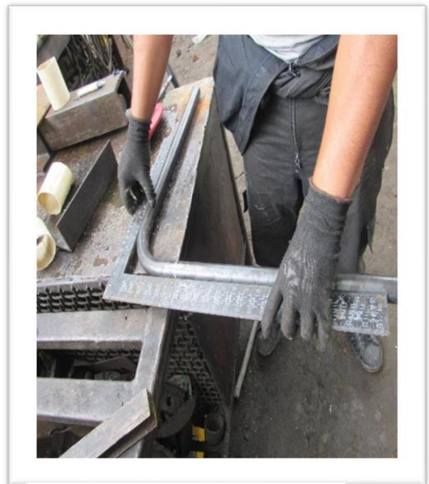
Fig. 39 Curvatura de ángulos
