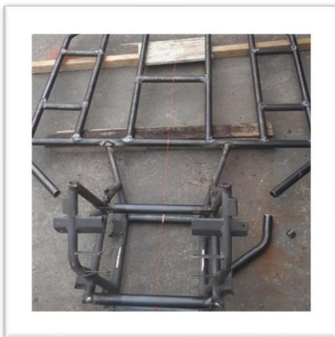
Fig. 46 Base de la estructura con el bastidor
