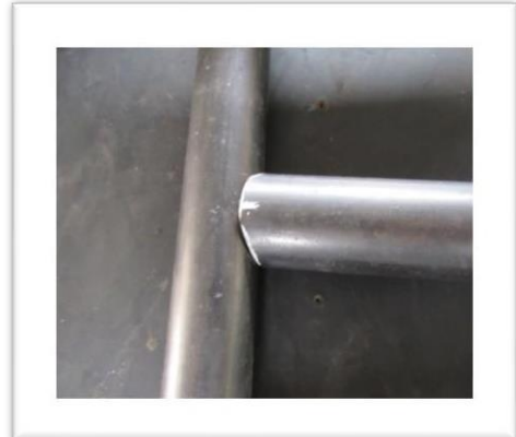
Fig. 44 Unión de tubos
