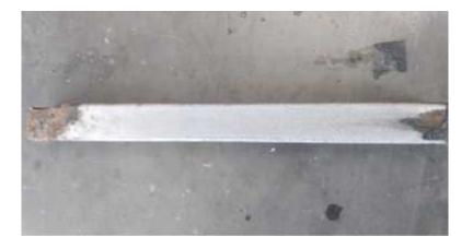
Procedemos a lavar con agua hasta retirara todo el recubrimiento, si aún presenta oxido repetimos todo el procedimiento hasta que quede libre de óxido.
