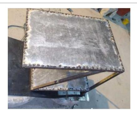
Para la ubicación de las ruedas podemos usar perno-tuerca, remaches e incluso soldadas. Si se decide asegurar con pernos o remaches, con un taladro aremos agujeros en la posición de la base de la rueda.
