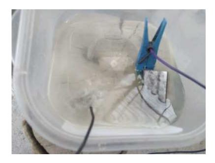
Dejamos una hora (dependiendo del tamaño de la pieza) hasta que se presente una capa de impurezas causada por la reacción química delos componentes de esta práctica.
