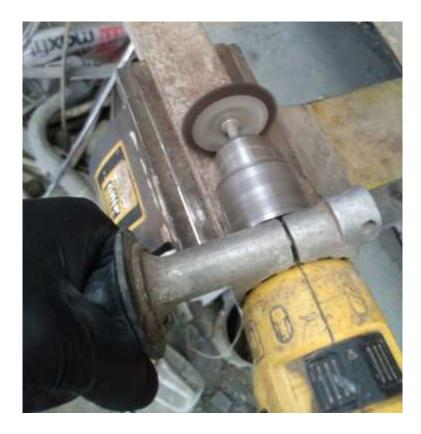
Este proceso, no es muy efectivo en comparación al lijado, ya que no logra expulsar todo el óxido existente, por esa razón el resultado es diferente.
