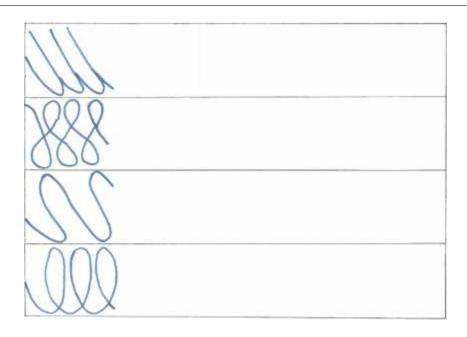
Finalmente, con una pinza de soldar y un marcador de cualquier color simulando un electrodo revestido realizamos todas las caligrafías.
