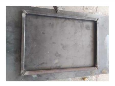
Luego cortaremos dos pedazos de tubo cuadrado de 67cm de largo, y en uno de sus extremos tendrá un corte de 45°.y la soldaremos de la siguiente manera.
