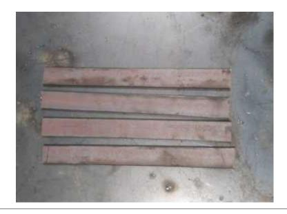
Ubicamos las pletinas en paralelo y punteamos sus extremos para evitar que se desacople. Posteriormente se procede a cordonear con los diferentes tipos de caligrafía de soldadura todas las uniones entre pletinas por ambas caras.
