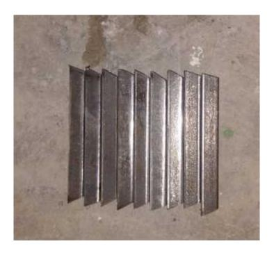
Con la ayuda del molde ubicamos los trozos de varilla en su contorno y procedemos a puntear con electrodo revestido
