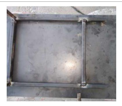
Una vez llegado a este punto cortaremos tres pedazos de diferente medida, dos de 57,5cm, estos con corte a 45° en uno de sus extremos y un último de 50cm con corte a 45° en cada extremo.
