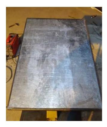
Y de 60,5cm \* 48cm para el piso superior. Estas se pueden remachar como también soldar, si se decide soldar, los puntos entre suelda y suelda deber de ser entre 3cm y 4cm.
