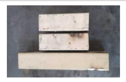
A 5 cm del filo del tubo realizamos un corte de 16cm de largo en una sola cara.
