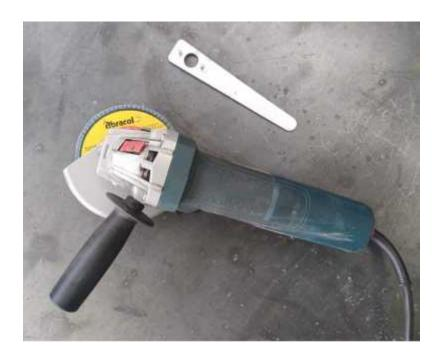
Tanto para el corte como para el pulido en las practicas se usará amoladora juntamente con discos de corte y discos de lija. Como todo trabajo conlleva sus riesgos, necesitaremos portar equipo de seguridad como gafas de protección, guantes de trabajo, mascarilla y protección auditiva adicionalmente la amoladora deberá llevar obligatoriamente el protector de disco y el mango para mejor maniobrabilidad y evitar accidentes.
