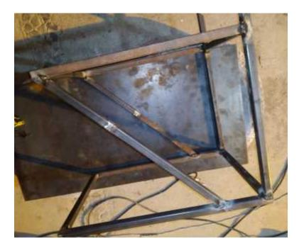
Para el manillar de nuestro carrito necesitaremos cortar dos trozos de 12,5 cm con corte a 45° en uno de sus extremos y poder soldarlos en la siguiente posición.
