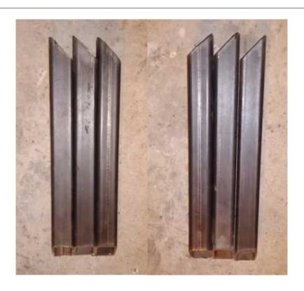
Una vez terminados todos estos cortes, se empezara al aramado de la estructura con la ayuda de la escuadra, y soldadora de arco electrico. Para este paso es preferible puntear cada una de las esquinas que se va uniendo para evitar descuadres al finalizar de unir las piezas.
