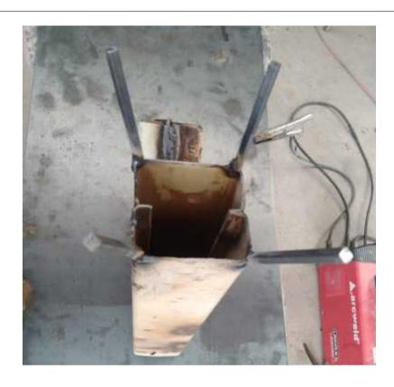
Con la platina de 65cm haremos un circulo. (este se puede hacer usando como molde un tambor de freno) o a su vez la podemos seccionar y armar un cuadrado en vez de un circulo. A esta la uniremos con las varillas anteriormente soldadas.
