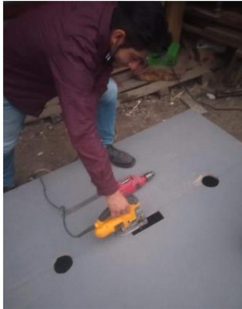
*Nota:* Una vez culminado el montaje de todas las piezas en la figura 17 procedimos al desarrollo de sus elementos haciendo los diferentes orificios en los cuales van sobre puestos los accesorios como, radio, parlantes, ventiladores, alarma, luces, y todos sus elementos.
