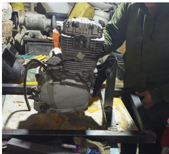
*Nota.* La gráfica siguiente nos indica la creación de la base donde va a ir sujetado dicho motor.
