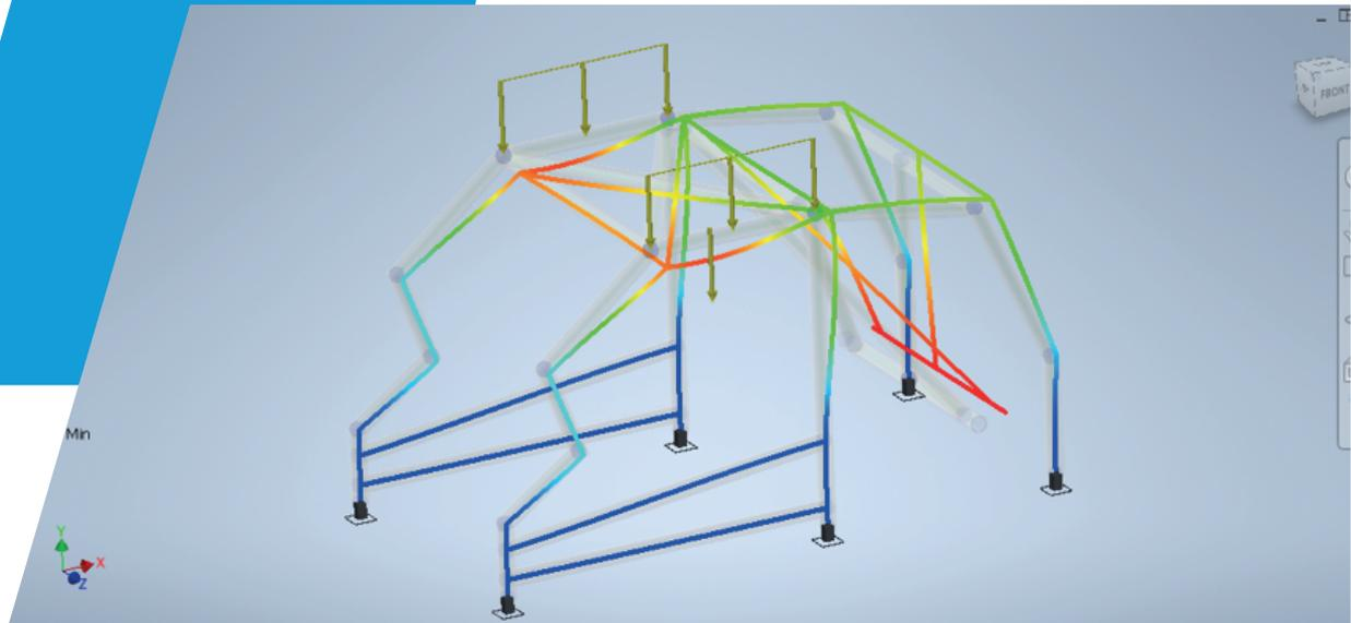
El resultado obtenido por el Software CAD es de 404.1 la deformación está en el rango de las normativas FIA, se le aplicó una fuerza de 19620 N, lo cual se observa que el resultado cabe dentro de las normativas antes mencionadas.
