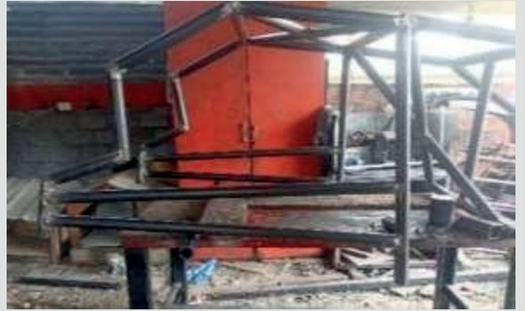
Para realizar los tirantes o refuerzos opcionales, se utilizó un tubo de 2 pulg. de 2 mm, tomamos un anclaje de amortiguador a amortiguador, pasando un tubo de 85 cm, así mismo tomamos la mitad del mismo para proceder a soldar otro refuerzo opcional que iría a la parte superior, cabe mencionar que este tubo mediría 79 cm.
