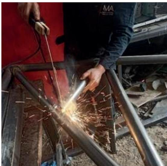
Se puede examinar la unión del otro tirante del refuerzo del techo con una medida de 51 cm con un biselado para la unión del otro tirante.
