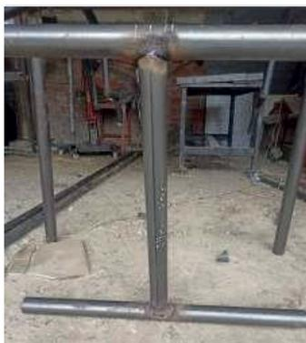
La figura 29 encontramos el otro refuerzo opcional que nos da las normativas en este caso se lo puede ver de forma vertical con una medida de 79cm usando un tubo de 2 pulgadas con un espesor de 1.2mm.
