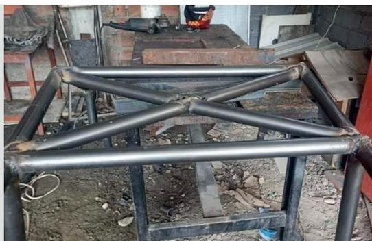
Por otra parte para realizar el tirante diagonal en X tomando un tubo de 2 pulg x 2mm tomamos las medidas desde el arco principal hacia el refuerzo que va unido hacia el anclaje de los amortiguadores. Realizamos un corte de 120 cm y así mismo un biselado de 3,5 cm para obtener un lado de 16,5 cm para así encaje con el arco principal y el arco lateral.
