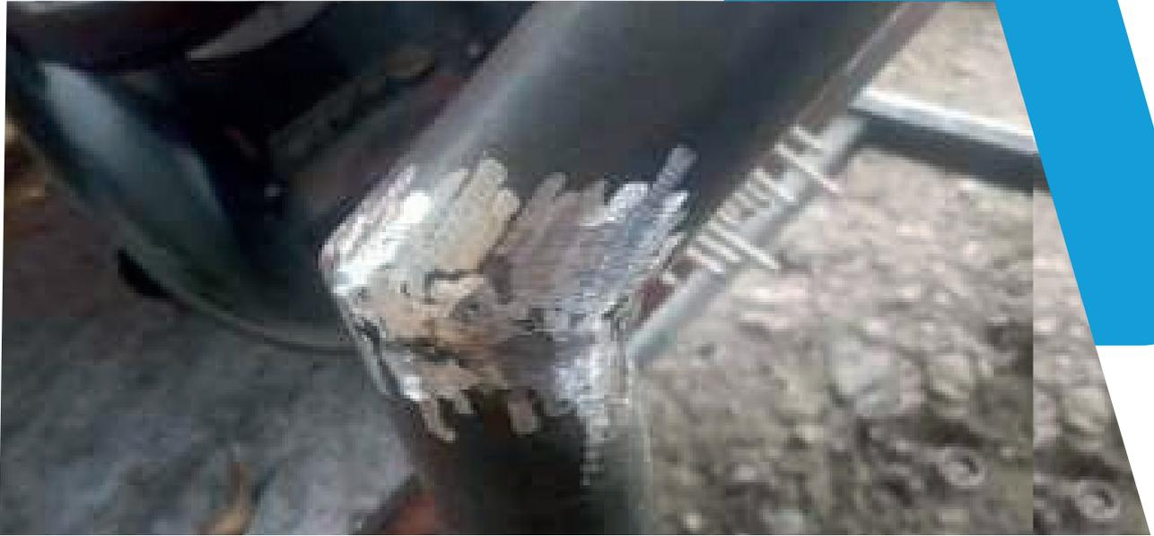
Se puede observar el pulido de la estructura ya una vez acabado de soldar todo el Roll Bar.
