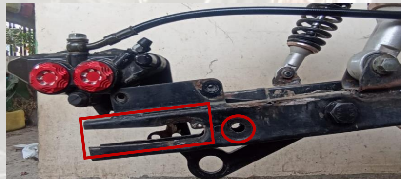
FIGURA N° 18: corte y orificio del oscilante. FUENTE: proyecto
