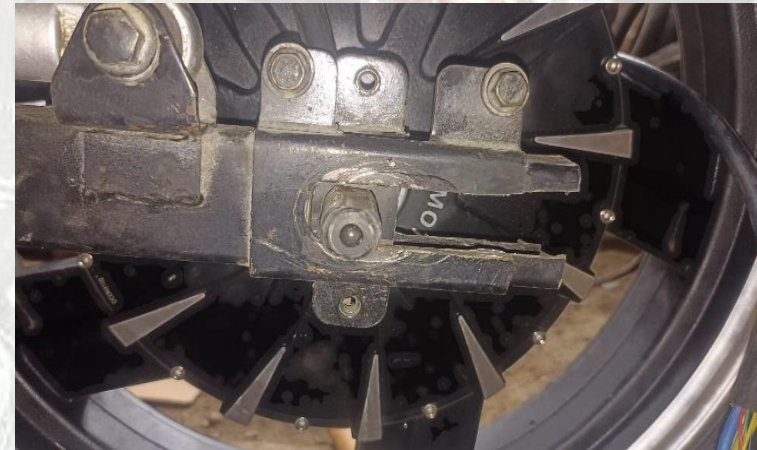
FIGURA N° 17: corte del basculante de la moto original. FUENTE: proyecto
