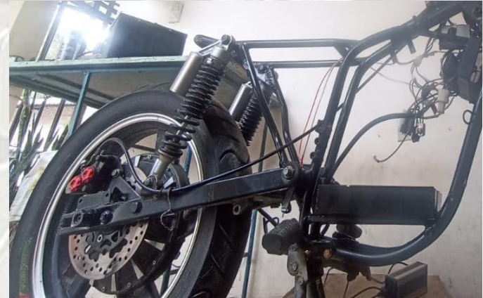
FIGURA N° 20: motor eléctrico montado en el chasis. FUENTE: proyecto
