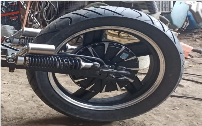
FIGURA N° 19: motor eléctrico montado en el chasis. FUENTE: proyecto
