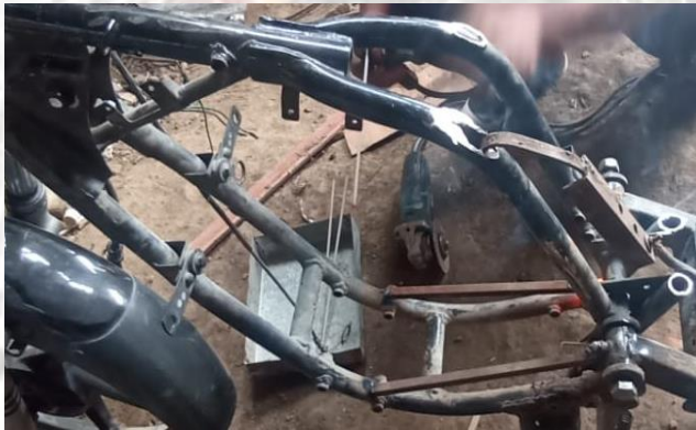
FIGURA N° 16: chasis con el corte realizado FUENTE: proyecto
