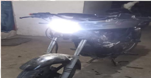
FIGURA N ° 37: faro led funcionando. FUENTE: proyecto
