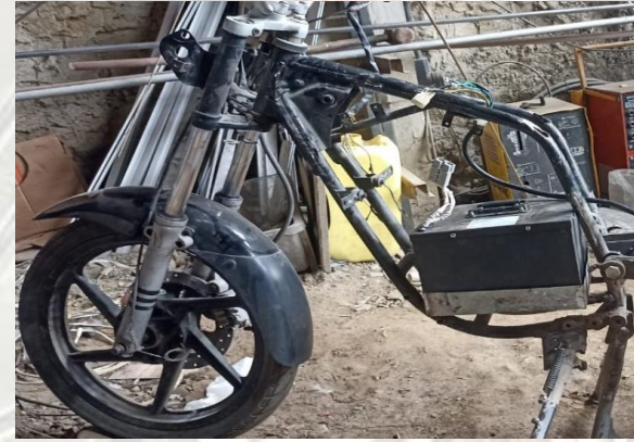
FIGURA N° 26: resultado de la instalación de la batería FUENTE: proyecto
