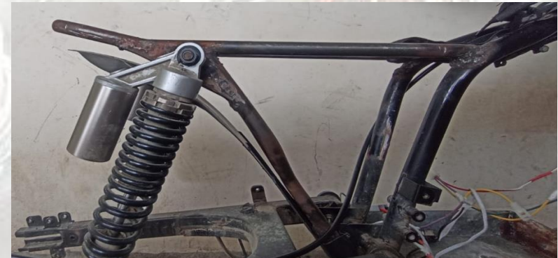
FIGURA N° 28: se toma el ángulo de inclinación de los brazos del sillín. FUENTE: proyecto
