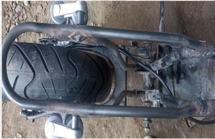
FIGURA N° 27: el sillín debe estar recto a ambos lados. FUENTE: proyecto
