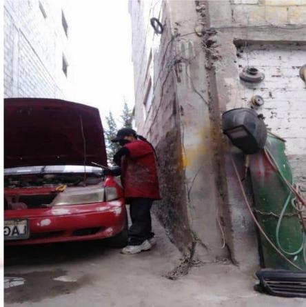
El vehículo presenta un desacople en la estructura del compacto. Para ello se toma medidas de extremo a extremo, para ser más precisos desde el ultimo perno de guardafangos izquierdo al otro punto del perno derecho, ambos son medidos en equis y arrojan medidas de 1,52 izquierda y 1,54 derecha. como se observa en la (Figura 59)
