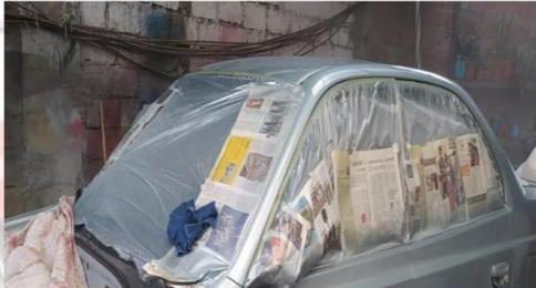
El empapelado debe ser trazado de forma precisa en los cauchos o faros tal como se observa en la (Figura 48), el empapelado respeta las líneas del elemento seleccionado.
