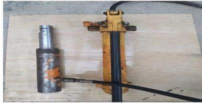
Este equipo permite estirar, empujar y extender la pieza que se va a enderezar, funciona con un tubo hidráulico que funciona mediante presión de aceite. (Figura 4)
