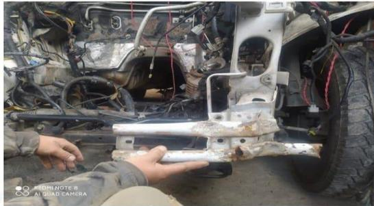
Una vez acoplada la pieza se procede a colocar las piezas sustituidas, como se observa en la (Figura 69) ir midiendo cada pieza para que coincida la pieza y no se descuadre al momento de armar toda la parte de carrocería.
