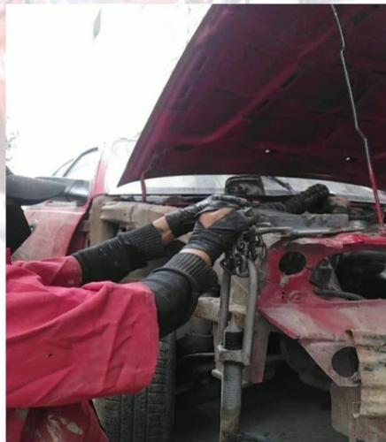
Una vez colocado el templador en la estructura de compacto con la columna de enderezado, antes de comenzar a templar colocamos tacos de madera que contrapongan la carrocería para que no se descuadre y a su vez el vehículo no se regrese completamente como se observa en la (Figura 63).
