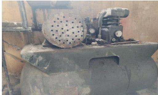
Herramienta dispensable para el pintado del vehículo, ya que funciona a presión de aire y con un switch eléctrico, que funciona con un breker a 220. (Figura 16)
