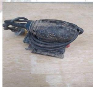
Maquina de lijar cuadrada es utilizada para lijar partes planas de la superficie (Figura 16)
