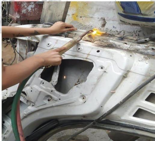
Una vez enderezada y acoplada la pieza se procede con el proceso de soldado, para que las piezas no pierdan las propiedades adquiridas en el templado. (Figura 68)
