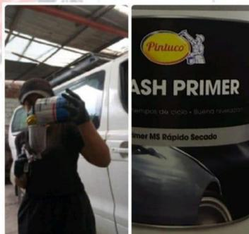
**Paso 2.** Una vez aplicado el fondo el secado del fondo oscila entre uno 20 a 30 minutos todo esto depende del tiempo climático, ya que si se está a una temperatura estable de calor el secado es más rápido, pero si el clima esta templado este ser más tardado. (Figura 45)
