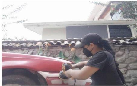
**Paso 6.** Finalmente, se con una lija de agua A-99 240 se pasa por todo el material lijado para proceder al siguiente proceso. (Figura 43)
