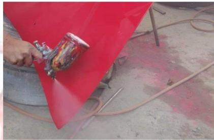
Una vez secada la pintura se procede a la aplicación del barniz (Figura 53) este es aplicado aun de manera más rápida ya que es más líquido que la pintura, además que se tiene que tener más precisión de aplicación, terminado el proceso de pintura se procede a sacar todo el papel y cinta cuidadosamente para evitar fallas.
