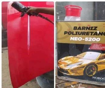
Los tiempos de secado de la superficie oscilan dependiendo la cantidad se secante y tiempo climático mientras tanto el vehículo no debe estar expuesto al agua y polvo.
