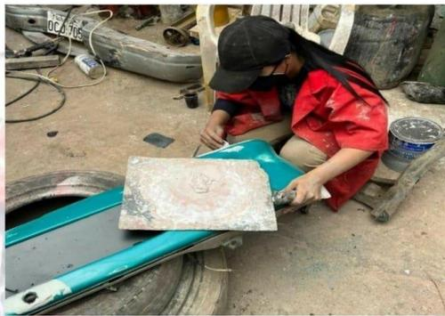
**Paso 5.** Una vez secado debe aplicarse una lija de hierro para desbastar el exceso de masilla, posteriormente una vez la desbastada la zona se procede a pasar lija P80 amarilla con la máquina de lijar para suavizar y evitar gradas de masilla en el metal. (Figura 42)
