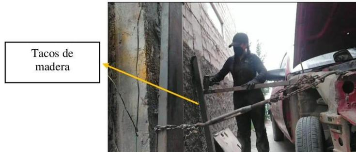
Posteriormente se procede a templar el área desacoplada, una vez templada el área observamos hundidos y salientes externas provocadas por el golpe, para realizar el proceso de enderezado se cuenta con la utilización de herramientas artesanales de fuerza tales como combos tases, palancas, extractores y perros de enderezado. Como se observa en la (Figura 64,65, 66 y 68).
