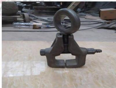
En la (Figura 5) se observa la mordaza, esta permite el enderezado de carrocerías mediante un antibloqueo que posee al ser templar cada pieza.
