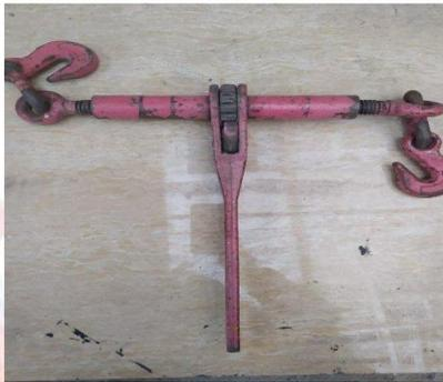
Permiten tensar y estirar de forma mecánica sin necesidad de utilizar cadenas de ajuste. Como se observa en la (figura 6)
