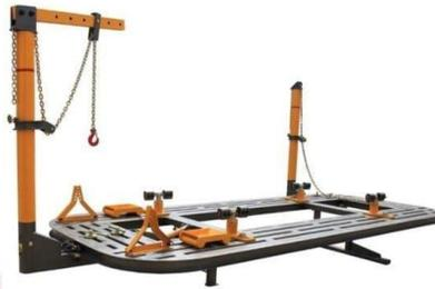
Es un banco donde se utilizan herramientas de tracción, para devolver el chasis y la carrocería a sus medidas originales. Para esta operación se utilizan actuadores hidráulicos o portos y cadenas de tracción, para estirar la lámina y recuperar la forma inicial. (Figura 13)
