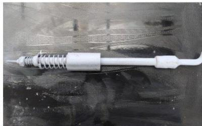
(Figura 7) Permite extraer el golpe en áreas de difícil acceso, es introducido en la lata de manera que al contraer una acción de fuerza permite extraer el golpe, esto se lo realiza en zonas tales como túneles, puertas y biseles.
