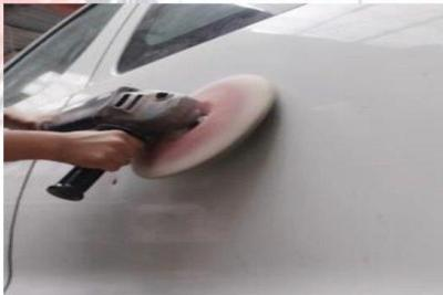
Esta máquina funciona con una mota que sirve para trabajos de pulido, esta posee un botón de regulación, que permite que trabaje mediante la fuerza que se le aplique (Figura 19)
