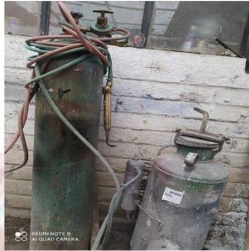
Funciona a base de carburo y oxígeno y da un mejor acabado de suelda para el metal, permite el revestimiento del metal (Figura 20)
