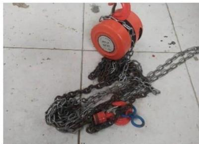
En la (Figura 2) se trata de una máquina que contiene dos poleas en forma de gancho y una cadena que pasa por el centro de los dientes de la máquina, que contiene una palanca que engrana el sistema de forma mecánica ya que reacciona mediante una acción de fuerza aplicada al vehículo con el fin de estirar para o trasladarlo a un lugar diferente.
