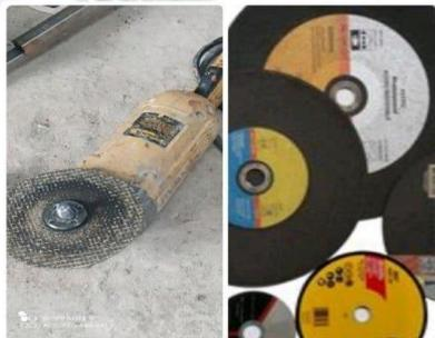
Es una herramienta de corte necesario para el acado de carrocerías y rectificación de superficies, ya que es una herramienta que funciona a altas revoluciones y funciona con varios discos de acabado como los siguientes:
