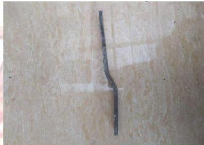
(Figura 9) Es una herramienta de enderezado que es utilizada para aplanar chibolos en zonas tales como capos y techos.
