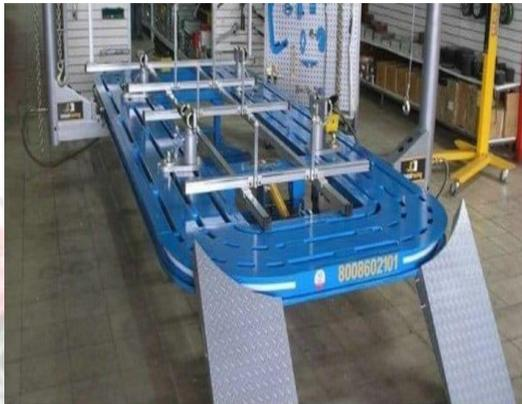
Bancos que utilizan utillajes o figuras como: bloques, varillas, cilindros y puntas, que se arman entre sí para llegar a los puntos de la carrocería, otros bancos traen compas de varas para medir en las diferentes dimensiones, todo esto para lograr determinar la magnitud del daño y servir de guía para retornar la carrocería y el chasis a las dimensiones originales.
