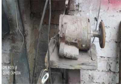
Herramienta utilizada para dar acabado al metal, tal como desbaste y pulido del material, además de afilar instrumentos en punta.
