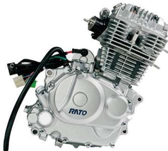
*Nota.* El gráfico representa un motor Monocilíndrico CB 250 cc. Tomado de *Rato CB250 (RW167MM)* por ENGINESPECS, 2022.
