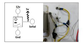
Estos dispositivos se encuentran ubicados en toda la parte izquierda del tablero de la maqueta, para la simulación de los dos sensores se utilizó una rueda fónica con un motor de ventilador con regulación de velocidad para simular el movimiento del cigüeñal.
