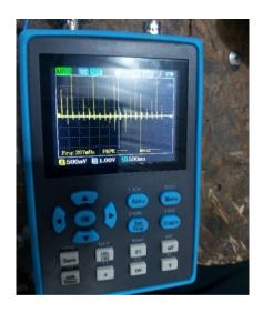
**Sensor MAP.** Para el sensor MAP se utilizó únicamente el osciloscopio donde muestra la variación de voltaje dependiendo del vacío generado en el sensor. En este caso nos indica un voltaje de 2.21 voltios (V) a una presión de unos 0.4 bares (bar) tal como nos indica la onda senoidal en el osciloscopio. En este sensor su función es que a mayor vacío menor voltaje siendo inversamente proporcional el vacío.
