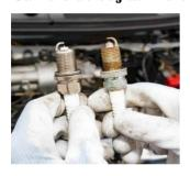
Mover bobinas para reemplazar las bujías cada 50.000km
