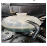
Verificar el estado y el nivel del fluido del sistema de refrigeración, de acuerdo a la condición se remplaza o se completa. D
