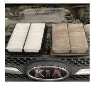
Se retira el ducto del aire para remplazar el filtro B usado por un nuevo.
