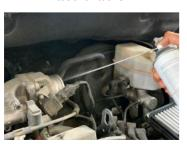
Se desmonta el ducto del aire, ponemos el motor en marcha y con la ayuda de un spray lavar la entrada de aire, logrando así una entrada correcta de aire y sin obstáculos a las cámaras de combustión.
