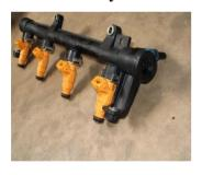
Se extrae la flauta del múltiple de admisión sacamos los inyectores para introducir al ultrasonido posteriormente se comprueba en el banco de prueba, se cambia microfiltros y se procede al montaje.
