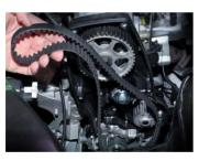
Se extrae bandas de accesorios posterior a esto se desmonta las tapas protectoras de la distribución se sincroniza tiempo de encendido se extrae la banda y se reemplaza rodamientos y templador D
