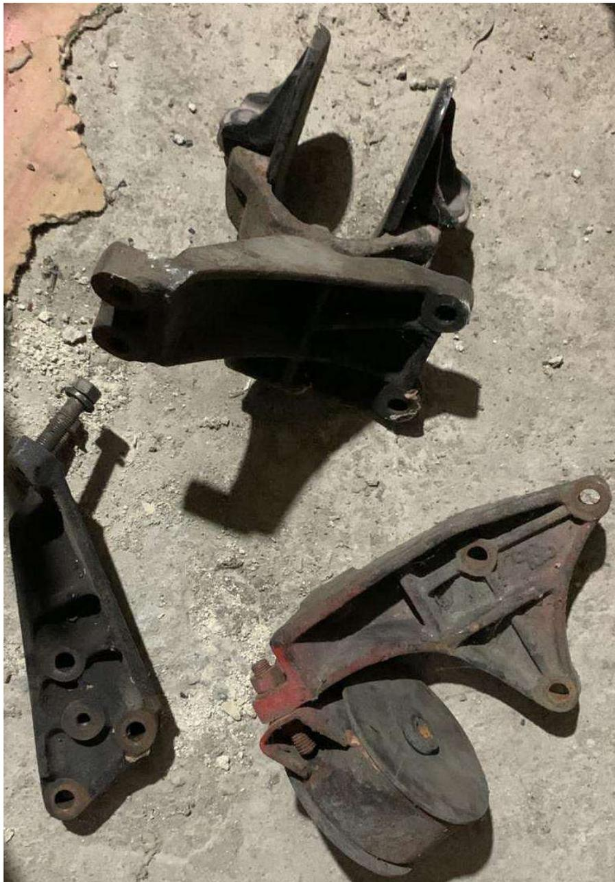
**Nota.** La figura hace referencia a las bases del motor y la transmisión. **Tomado de:** Autores - Titulación.
