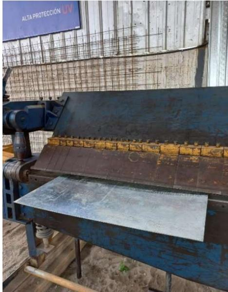
*Nota.* En la figura se muestra el proceso de doblado de lámina. Imagen tomada por, Víctor Jimenez, (2023).
