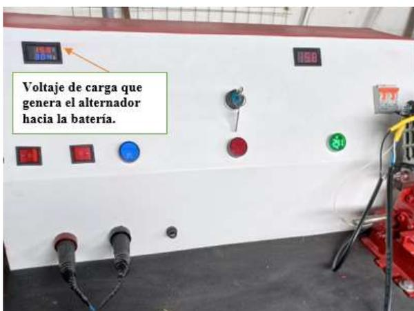
*Nota.* En la figura 45 se muestra el voltaje que genera el alternador hacia la batería. Imagen tomada por, Víctor Jimenez, (2023).
