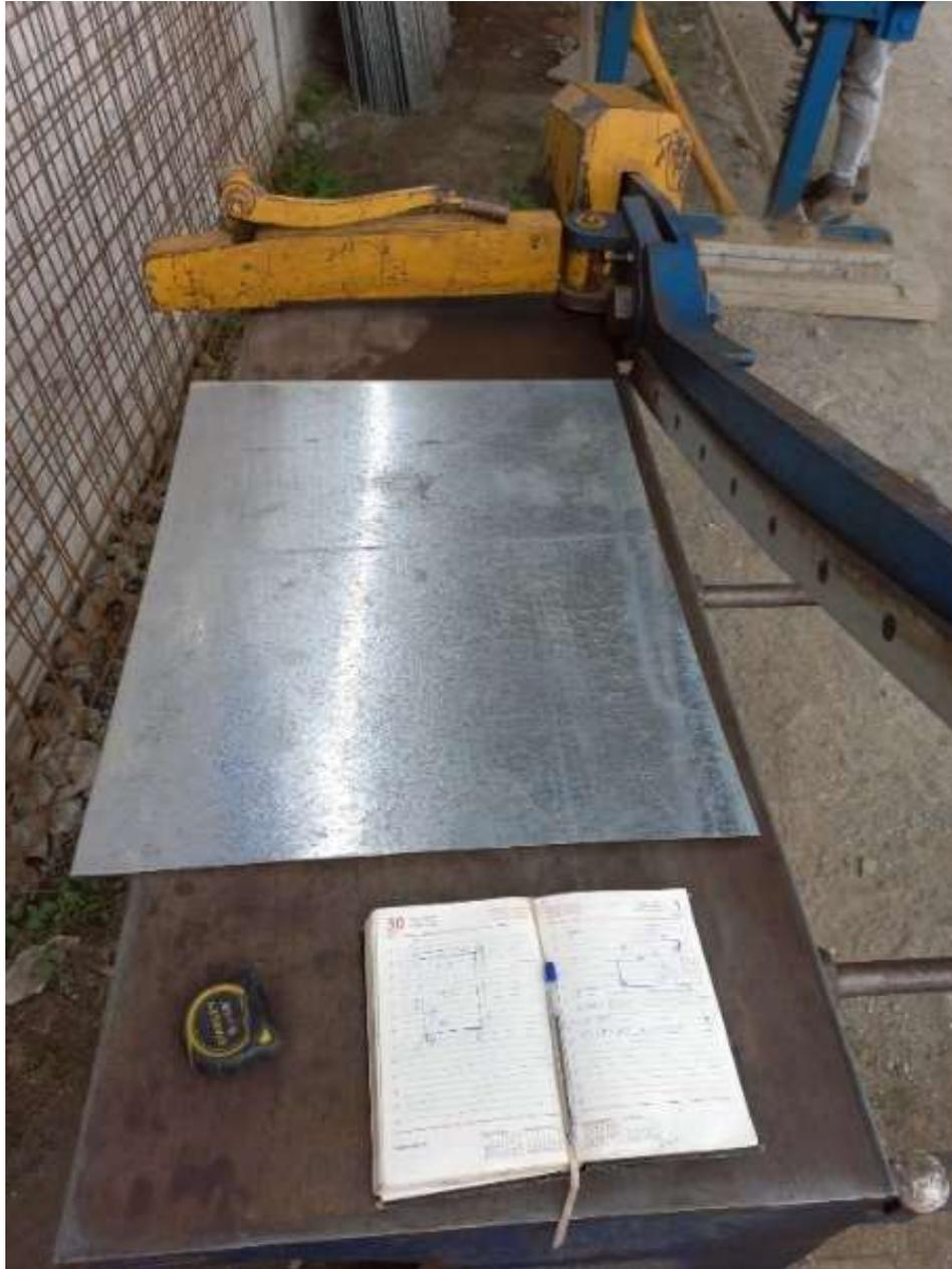
*Nota.* En la figura se muestra la cortadora de la lámina galvanizada. Imagen tomada por, Víctor Jimenez, (2023).
