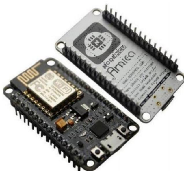
*Nota:* Ilustración de placa microcontrolador NodeMCU Esp8266 de datos que utiliza el protocolo Wi-Fi.
