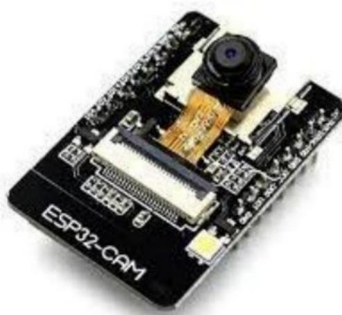
**Nota:** microcontrolador ESP32-Cam, dispositivo que está dentro de la familia ESP32. Tomado de:
