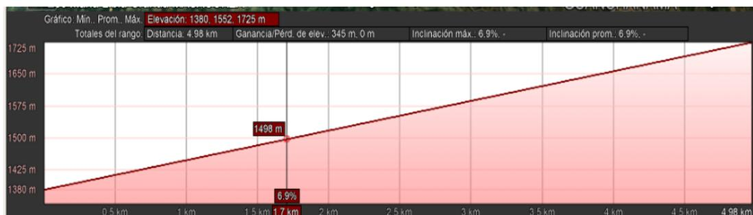
*Nota.* Captura de pantalla tomada de Google Earth demostrando la altura de la línea del radioenlace entre la antena emisora y la receptora
