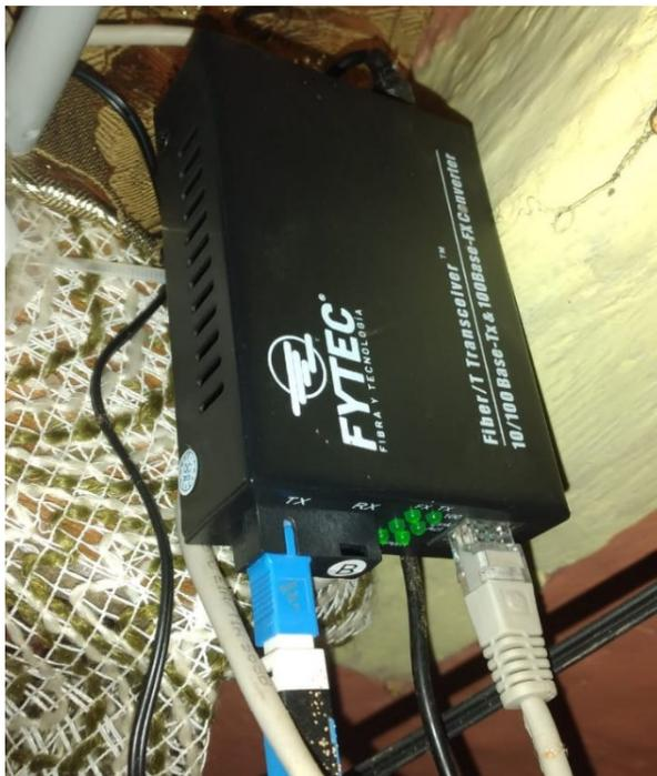
*Nota.* Fotografía tomada realizando la instalación del conversor de medios en el domicilio de un abonado.
