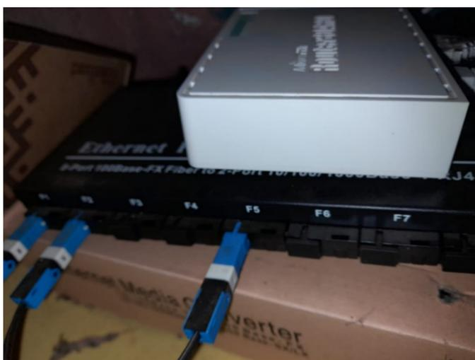
*Nota.* Fotografía tomada realizando las diferentes conexiones de la fibra óptica de los distintos usuarios al switch.
