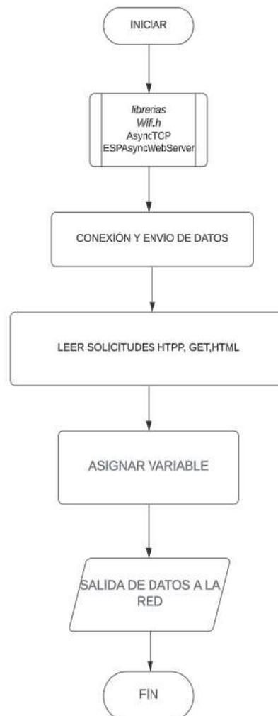
*Nota.* Esta figura hace referencia al proceso realizado para mantener una conexión de datos entre la interfaz web y el microcontrolador.
