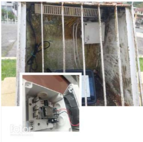
*Nota.* El prototipo se armó dentro de una caja plástica con ip65 y se instaló junto a su fuente de alimentación, dentro de un gabinete metálico existente.
