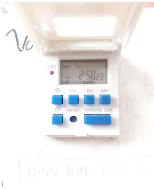
Nota. Esta imagen hace referencia a las pruebas de programación del temporizador del modelo digital MT15.
