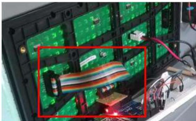
*Nota.* Conexión de pantalla al Arduino
