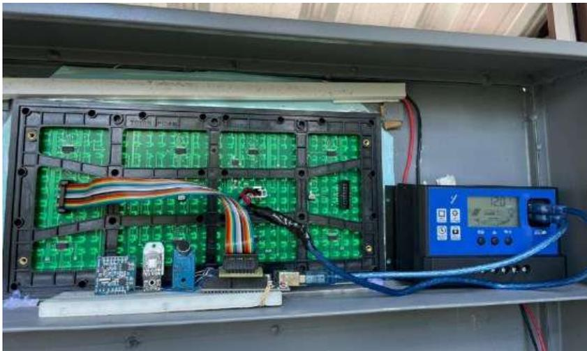
*Nota.* Sensores y sus conexiones
