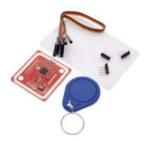
*Nota*. Modulo PN532 que se utilizara para la lectura de las etiquetas NFC. Tomado de <a href="https://roboticsec.com/producto/lector-de-tarjetas-rfid-13-56mhz-pn532-tarjeta-llavero/">https://roboticsec.com/producto/lector-de-tarjetas-rfid-13-56mhz-pn532-tarjeta-llavero/</a>
