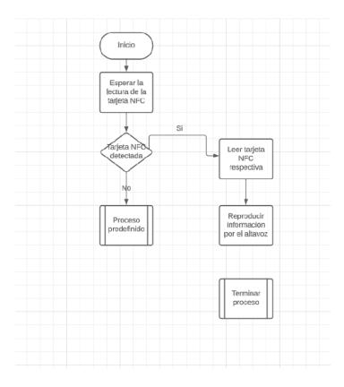
Nota. Diagrama del sistema de funcionamiento del dispositivo.
