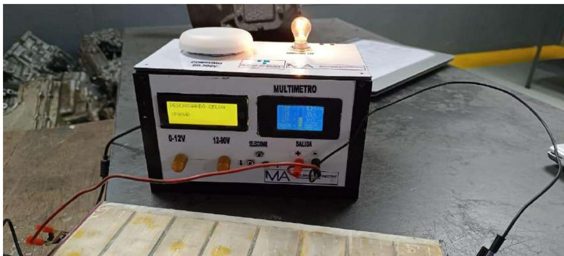
*Nota: Proceso de descarga de una celda de batería*
