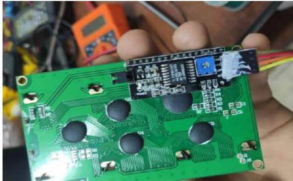
*Nota.* La imagen representa la conexión del arduino Nano al módulo I2C y pantalla LCD
