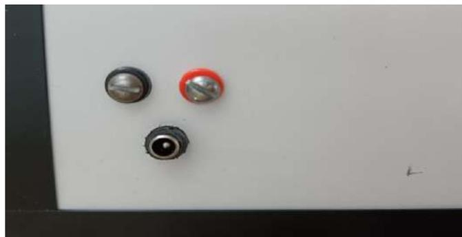
*Nota.* La imagen representa la ubicación de los tornillos para la conexión y distribución de los 12V
