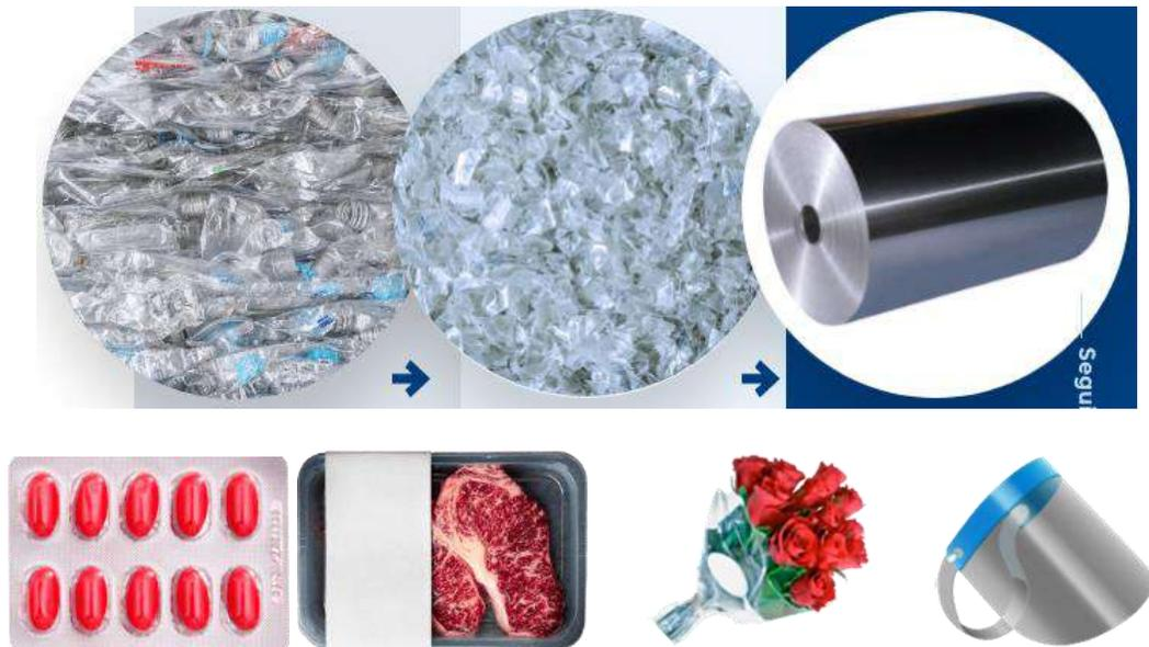
Imágenes tomadas de: <https://cersa.ec>. Las láminas de PET por medio de termoformado constituyen las aplicaciones mostradas debajo.
