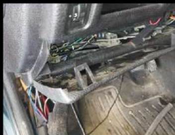
Figura 22. Identificación de la tapa de la fusilera interna. Tomado por Carrión E & Escudero J, 2023.
