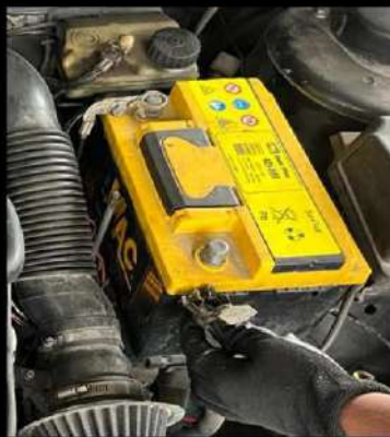
Figura 3. Desmontaje de la batería. Tomado por Carrión E. & Escudero J, 2023.
