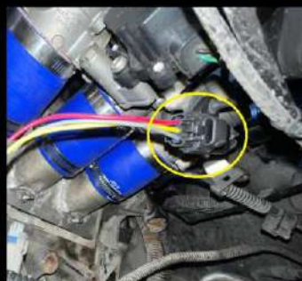
Figura 41. Ubicación del sensor MAP. Tomado por Carrion E, & Escudero J, 2023.
