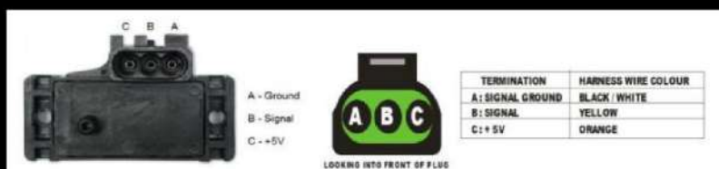
Figura 42. Pin Out del sensor MAP. Tomado de Haltech Pro, 2015.
