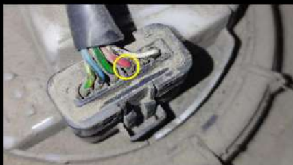
Figura 59. Identificación del socket de la bomba de Combustible. Tomado Por Carrión E. & Escudero J, 2023.
