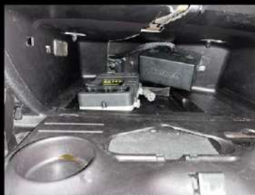
Figura 20. Ubicación de la ECU. Tomado por Carrión E. & Escudero J, 2023.
