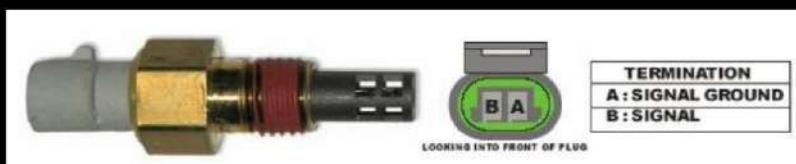
Figura 45. Pin Out del sensor IAT. Tomado de Haltech Pro, 2015.
