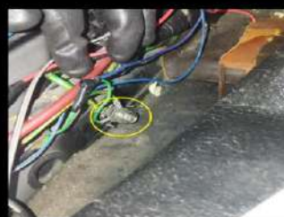
Figura 25. Masa a chasis del vehículo. Tomado por Carrión E. & Escudero J, 2023.
