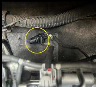
Figura 44. Ubicación del sensor IAT. tomado por Carrion E, & Escudero J, 2023.
