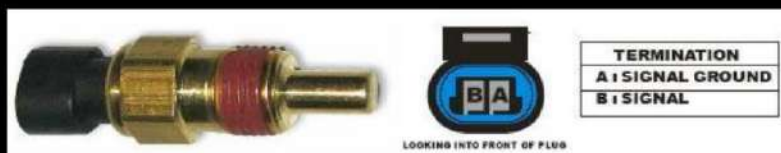
Figura 36. Pin Out del sensor ECT. Tomado de Haltech Pro, 2015.
