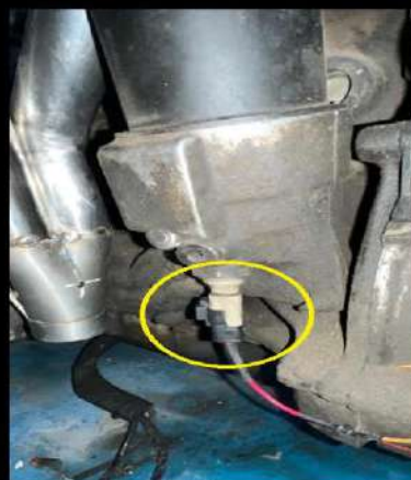
Figura 47. Ubicación del sensor OPS Tomado por Carrion E. & Escudero J, 2023.
