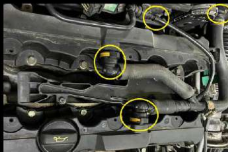
Figura 6. Identificación de mangueras de gases de aceite. Tomado por Carrión E. & Escudero J, 2023.
