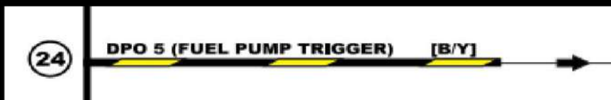
Figura 58. Pin de conexión del relé de la bomba combustible. Tomado de Haltech Pro, 2023.
