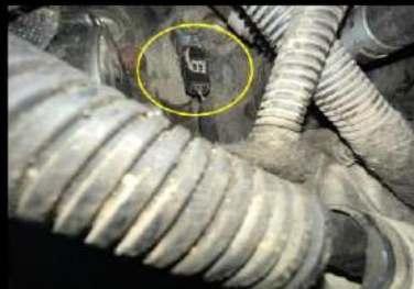
Figura 50. Ubicación del sensor KS. Tomado por Carrion E. & Escudero J, 2023.
