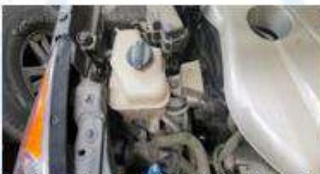
*Nota:* En la figura se observa el reservorio de refrigerante del motor de un Toyota Highlander, por Chico, H y Ludeña, C, 2023.
