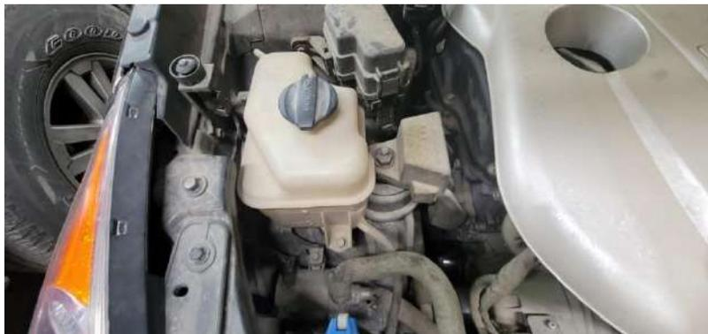
*Nota.* En la figura se observa el reservorio de refrigerante del motor de un Toyota Highlander, por Chico, H y Ludeña, C, 2023.
