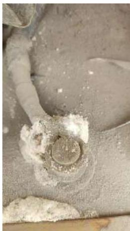
*Nota.* En la imagen se observa el sulfato en las placas de un Toyota Prius, por Chico, H y Ludeña, C, 2023.
