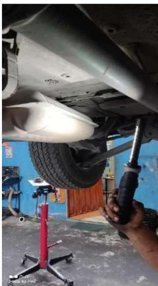
*Nota.* En la imagen se observa la revisión del sistema de escape de un Ford F150, por Chico, H y Ludeña, C, 2023.
