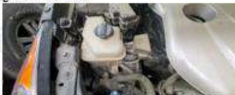
Nota: La figura muestra el reservorio de refrigerante del motor de un Toyota Prius, por Chico, H y Ludeña, C, 2023.
