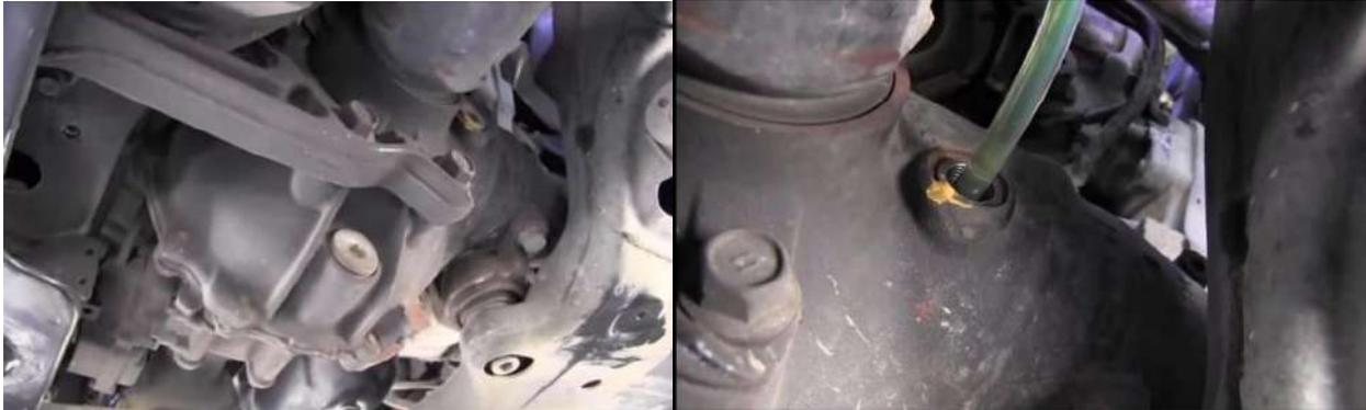
*Nota.* En la figura se muestra el tapón de llenado y de vaciado del Toyota Highlander, por Chico, H y Ludeña, C, 2023.
