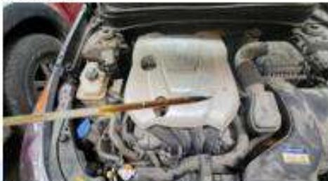
*Nota:* En la imagen se puede observar la varilla de medición del aceite de motor de un Hyundai Sonata, por Chico, H y Ludeña, C, 2023.
