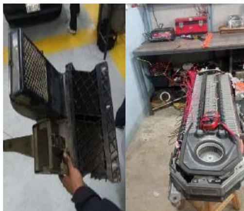
*Nota.* En la figura se observa el sistema de ventilación de las baterías del Toyota Prius, por Chico, H y Ludeña, C, 2023.
