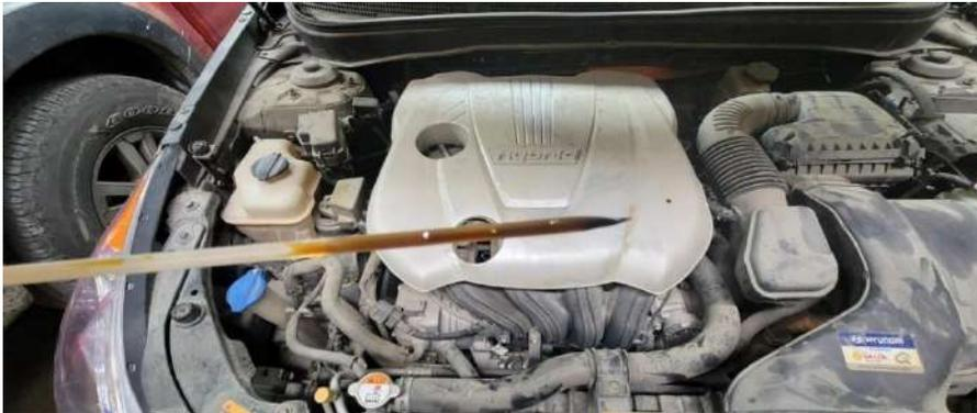
*Nota.* En la imagen se puede observar la varilla de medición del aceite de motor de un Hyundai Sonata, por Chico, H y Ludeña, C, 2023.
