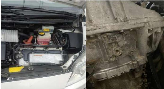
*Nota.* En la figura se observa el reservorio de refrigerante del inversor de un Toyota Prius, por Chico, H y Ludeña, C, 2023.
