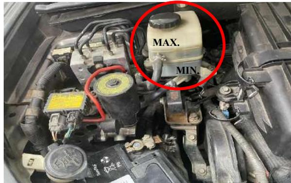
*Nota.* Esta figura muestra el reservorio del líquido de frenos de un Toyota Blazer, por Chico, H y Ludeña, C, 2023.
