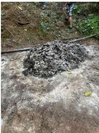
*Nota.* La figura representa a la cama de secado y se puede observar al lodo con adición de cal. Tomada por el autor, 2023.
