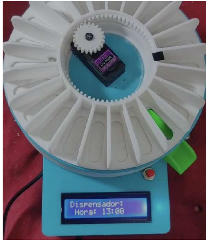
Figura 35 Implementacion del protipo del dispensador final
