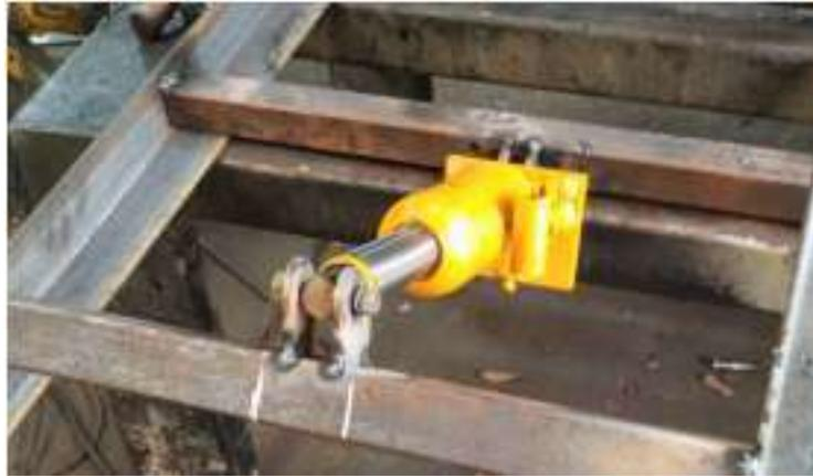
*Nota:* Las platinas van perforadas para que se introduzca un perno y así coloquen el gato hidráulico. Elaborado por Carrión y Sanmartín, 2023
