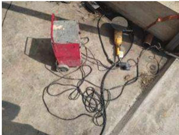
*Nota.* Herramienta utilizada para el proceso de soldadura y desbaste. Elaborado por, Valladarez y Vargas,2023
