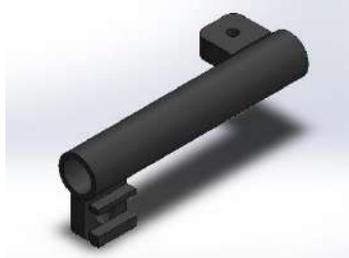
Nota. Imagen del diseño del pasador cilíndrico móvil. Elaborado por, Vargas y Valladarez,2023
