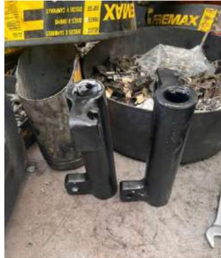
Nota. Imagen de la creación del pasador cilíndrico superior, tomada por Vargas y Valladarez,2023.
