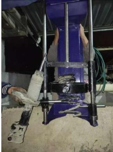
Nota. Imagen de la extracción del amortiguador de la espiral. Tomada por Vargas y Valladarez,2023
