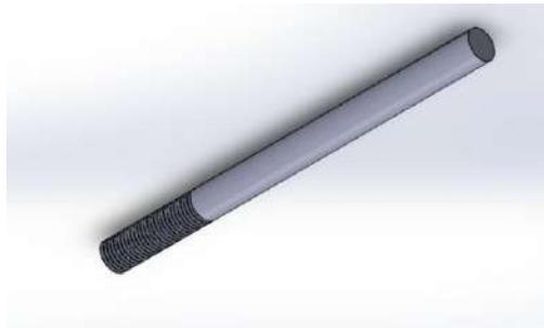
Nota. Imagen del diseño del eje roscada, tomada de software Cad. Elaborado por, Vargas y Valladarez,2023
