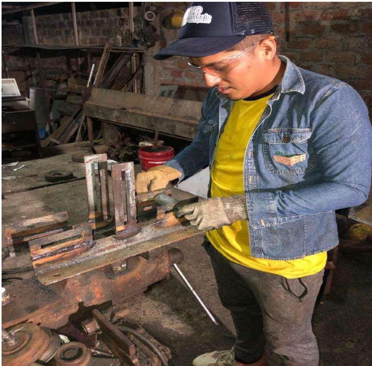
*Nota:* esta imagen indica el montaje de los rodillos en la estructura.
