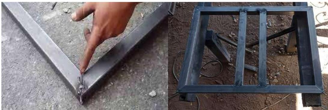
**Nota.** Imágenes sobre el proceso de soldadura de las partes del banco.
