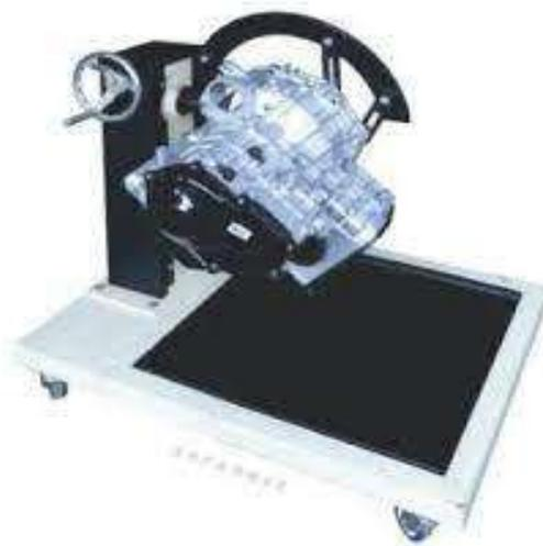
**Nota.** Imagen de un soporte de vuelco para transmisiones automáticas. Tomada de yalong, 2023
